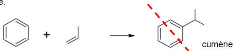
Étape 2 : réalisée à une température d'environ  $110^\circ\text{C}$ , sous une pression de 5 à 10 bar, en milieu basique.
